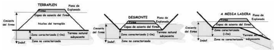
Figura 4.24 . Disposiciones de una carretera en terraplén, desmonte y media ladera
